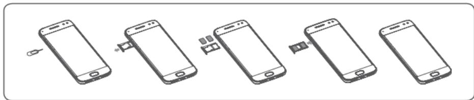
安装和取出SIM卡前先用顶针插入SIM卡槽的小圆孔，以弹出SIM卡槽。放入SIM卡时，确保SIM卡方向与SIM卡槽上的示意图一致。
