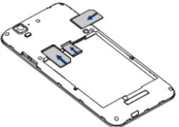
**注意:** 请注意保管手机卡, 不要弯曲或划伤, 也不要接触静电或浸水; 手机卡槽区分网络, 且需按照底壳上的标识正确放卡。手机不支持热插拔, 在插入手机卡和 Micro SD 卡之前, 请取下数据线并将手机关机。
