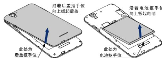
**后盖的拆取和扣合：**一手紧握机身侧面；另一手在抠手位扳起后盖。扣合后盖时，一手紧握机身侧面，另一手先扣住后盖的头部，再依次从底部往顶部扣紧后盖。
