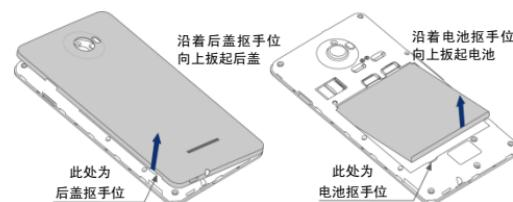
**后盖的拆取和扣合：**一手紧握机身侧面；另一手在抠手位扳起后盖。扣合后盖时，一手紧握机身侧面，另一手先扣住后盖的头部，再依次从头部往底部扣紧后盖。
