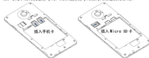
**注意:** 请注意保管手机卡, 不要弯曲或划伤, 也不要接触静电或浸水; 手机卡槽区分网络, 且需按照底壳上的标识正确放卡。手机不支持热插拔, 在插拔手机卡和 Micro SD 卡之前, 请取下数据线并将手机关机。
